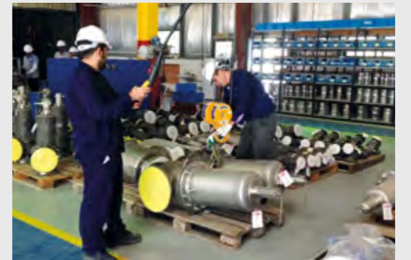
Montaje Binzagr para válvulas de seguridad LESER en Arabia Saudí
