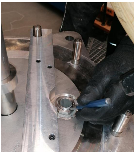
Abbildung 7: Sicherung Gegenmutter durch Körnerschläge
